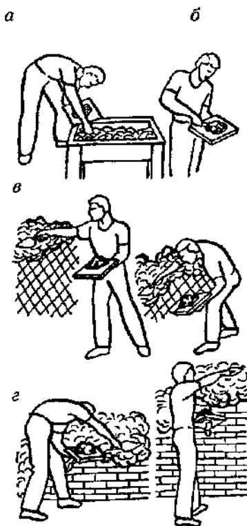
Рис. 84. Набрасывание раствора кельмой: а — накладывание раствора на сокол; б — взятие раствора кельмой с сокола; в — нанесение раствора слева направо на разных уровнях; г — нанесение раствора в положении справа налево на разных уровнях.
